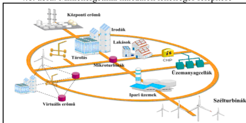
4.6. ábra: Minienergetikai hálózatok lehetséges felépítése
